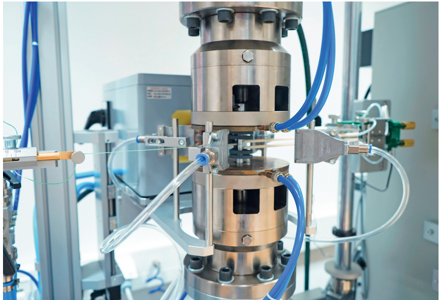
Bild 2. Induktionserwärmungssystem, aktive Kühlung und präzise Temperatur- und Dehnungsmessung erlauben normkonforme Prüfungen (© ZwickRoell)
